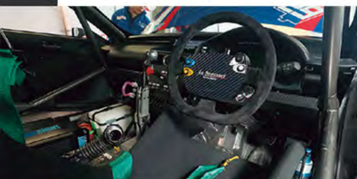
コックピットは市販車のRCのレイアウトを流用しながらも、レーシングカーらしく機能的にまとめられている。ウインカー等のスイッチ類は市販車をそのまま使用。
